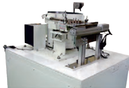
パーツフィーダ(ワーク供給装置)と 取出し・インサートヘッドの事例
